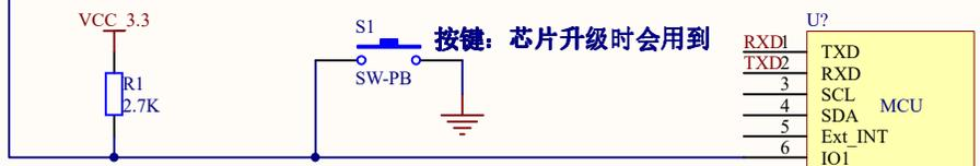
外接方案2: 工作电压稳定后, 大于5ms的低脉冲, 对M536a复位
