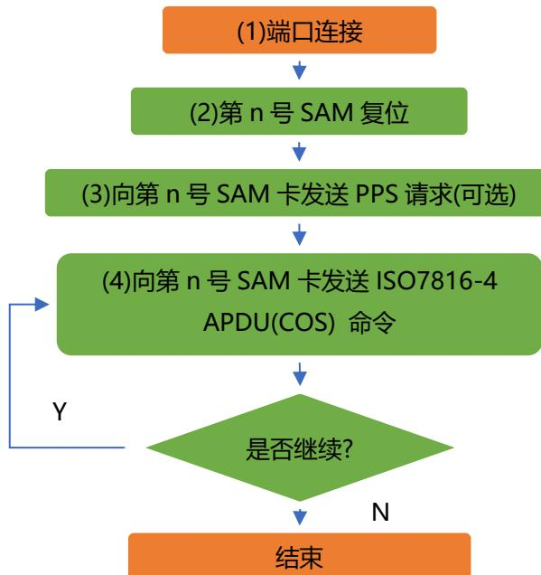
此操作流程是为了兼容老的型号读卡器，只能支持一个 PSAM 卡，对应读卡器内部的 1 号卡座位置。
