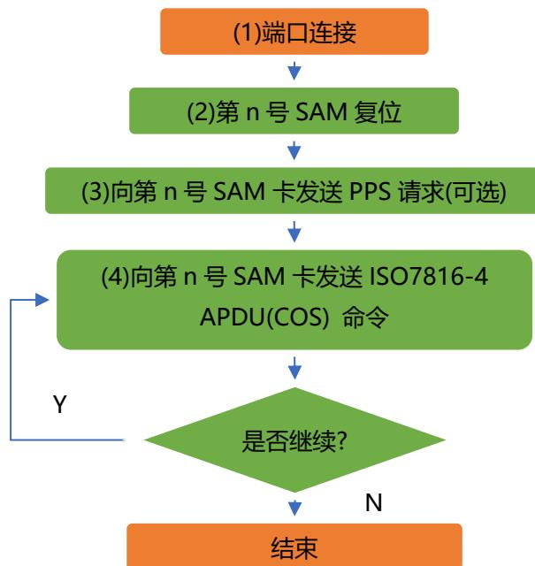
新的用户建议采用此操作流程，可以扩展对多个 PSAM 卡片的支持。
